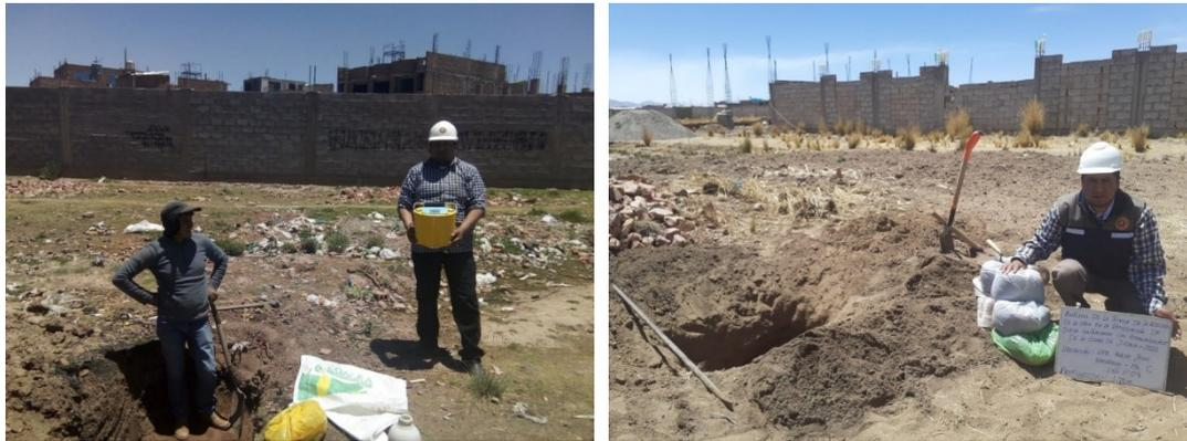
Nota. Las fotografías muestran el ensayo de Geogauge y la extracción de la muestra a una profundidad 1.70m (Muestra M-1).
