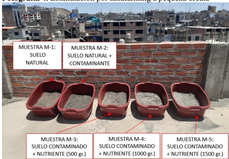
Nota. La fotografía muestra el método de degradación de contaminantes mediante el uso de la urea y el landfarming a pequeña escala como estimulante.
