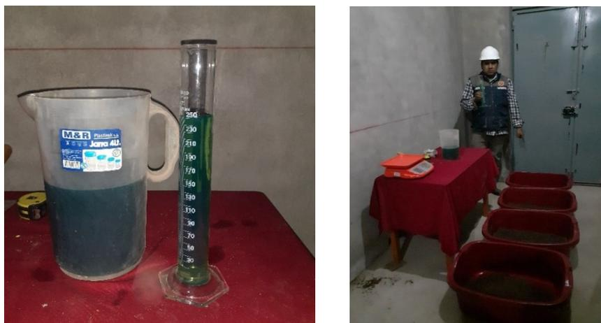
Nota. Las fotografías muestran el hidrocarburo (petróleo) en 250ml. utilizado para la contaminación del suelo.
