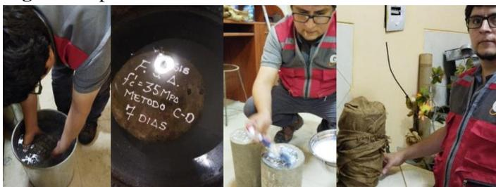
Para determinar la resistencia a la compresión del concreto  $f'_c=35$  MPa, se siguió la norma ASTM C39 y/o NTP 339.034 "Método de ensayo para determinar la resistencia a la compresión de especímenes cilíndricos de concreto". Se empleó una prensa hidráulica y se calculó la resistencia a compresión mediante la fórmula  $F'_c = F/A$ , donde F es la fuerza aplicada y A el área superficial del espécimen.
