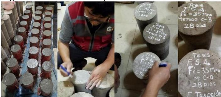
Una vez elaboradas las probetas, se procedió a aplicar los diferentes métodos de curado contemplados en la investigación: sin método de curado (20 probetas), método de anegamiento o inmersión (20 probetas), método de curado con mantas o costales húmedos (20 probetas), y método de curado con aditivo membranal (20 probetas). Se evaluaron dos edades de curado para cada uno de los métodos aplicados: 7 y 28 días. Una vez cumplidas estas edades, se procedió a realizar los ensayos correspondientes.
