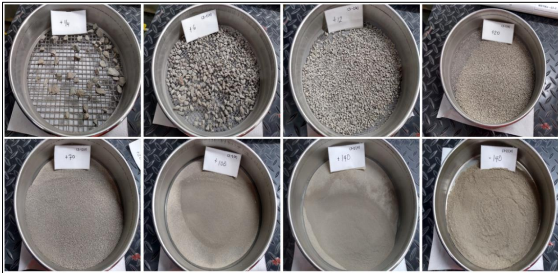
Figura 3. Detritos retenidos por las diferentes aberturas en cada malla utilizada, que muestran la heterogeneidad existente.
