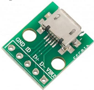
Figura 9. Módulo de suministro de energía de 5V para protoboard con Micro USB
