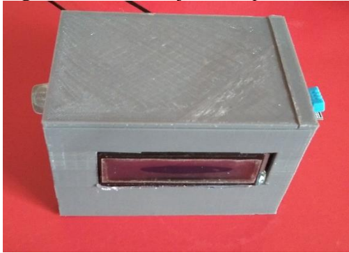
Figura 14. Ensamblaje del dispositivo en la caja impresa en polímero PLA
