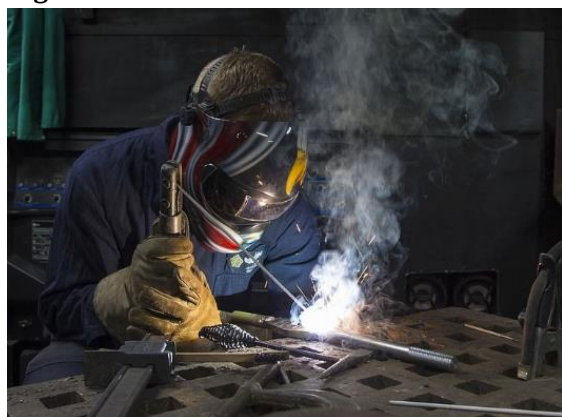
Figura 1. Proceso de soldadura SMAW
