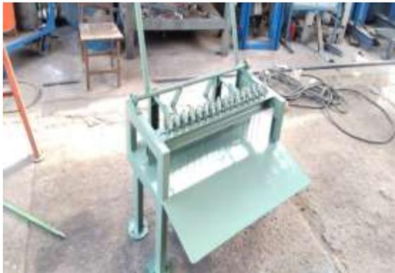
**Ilustración 2.** Cortadora de ladrillos.
