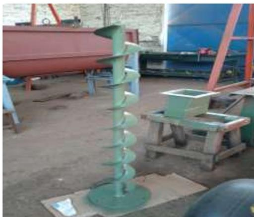
**Ilustración 3.**Eje helicoidal. Está dentro de la extrusora y lleva el adove a la cortadora para formar el rectángulo del ladrillo.
