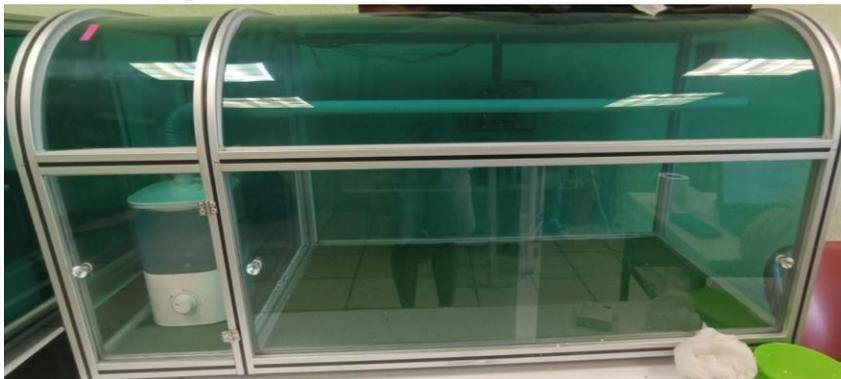
El biotopo funcionará través de un temporizador que estará adaptado al humidificador para que así este pueda hacer su actividad de manera controlada a través de un tubo PVC que va a rociar el agua, Termoeléctrico Peltier de enfriamiento, refrigeración que ayudará a estabilizar la temperatura cuando esta no se encuentre en las condiciones necesarias. Colocaremos 3 capas las cuales albergarán las 3 especies ya previamente mencionadas.
