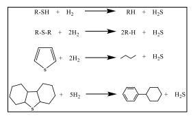
Durante este procedimiento, la entrada a la unidad de Tratamiento Hidrotérmico (HDT), que consiste en una mezcla de materia prima e hidrógeno, se dirige a través de un catalizador de Co-Mo a ajustes
