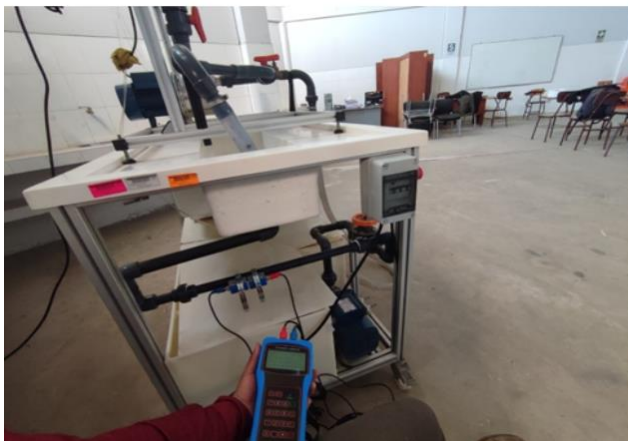
Figura5 Medición de muestras del caudal de la bomba
