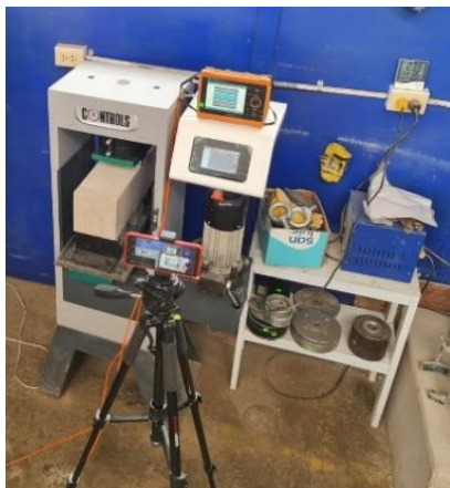
Figura 11. Ensayo de carga vs velocidad de ultrasonido
