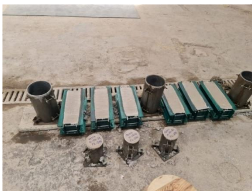
Figura 2. Fabricación de prismas para flexión
