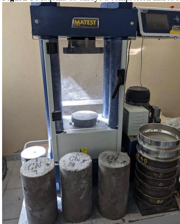
Figura 1 Máquina de ensaye a compresión marca Matest y probetas de concreto
