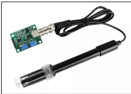
**Descripción:** Imagen de un sensor de pH conectado a un Arduino, incluyendo detalles de calibración y conexión.
