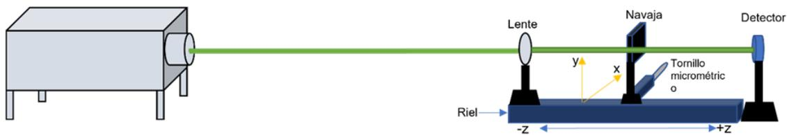
Para distancias cercanas al punto focal se colocará la navaja de manera que bloquee el spot del haz que se encuentra en plano transversal  $x - y$ . Posteriormente, la navaja se desplaza gradualmente, descubriendo el haz de manera controlada y permitiendo el paso de una fracción creciente de la intensidad, como se muestra en la Figura 4. En cada posición  $z$  de la navaja, se registra el cambio en la potencia detectada, la cual será
