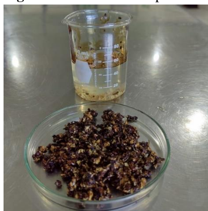
Figura 5. Mezcla recuperada de hidrocarburo-agua-olote
