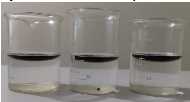
Figura 2. Simulación de derrame de petróleo a condiciones controladas en laboratorio
