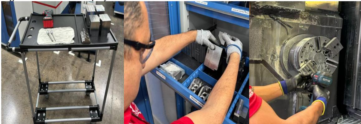
Nota: proceso interno Danfoss. (a) Estación móvil. (b) medición directo en máquina. (c) medición con goniómetro.
