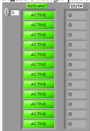
Como se observa en la Figura 6 existe un arreglo de valores booleanos que en caso de encontrarse en el valor “ACTIVE” se mostrara el número de unidad en “DUT #”. El DUT# está conectado al segundo panel para poder identificar a que valor corresponde a cada unidad.
