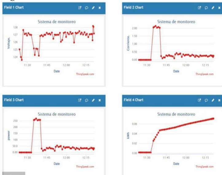
Derivado de las pruebas se pasó a instalar el prototipo en el ambiente donde recabaría la información.
