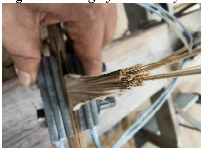
Figura 6. Fotografía del ensayo de tensión del bambú Guadua angustifolia
