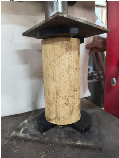
Figura 5. Fotografía del ensayo de corte para evaluar su capacidad a corte
