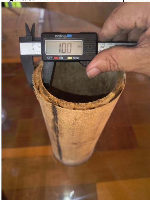
Figura 3. Toma de medidas de las probetas de bambú para evaluar sus propiedades
