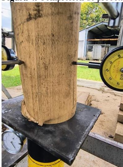
Figura 4. Compresión de probeta, posterior al fallo
