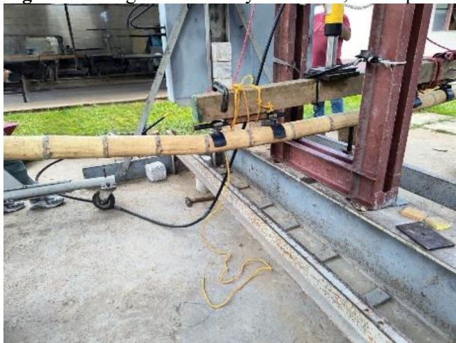
Figura 7. Fotografía del ensayo a flexión, de las probetas de bambú Guadua angustifolia
