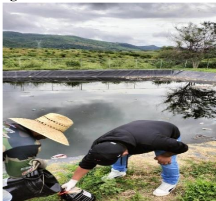
Figura 2. Toma de Muestra de Lixiviado en la fosa del Simar Sur Suereste
