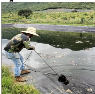
Figura 7. Toma de Muestra de Lixiviado en la fosa del Simar Sur suereste.
