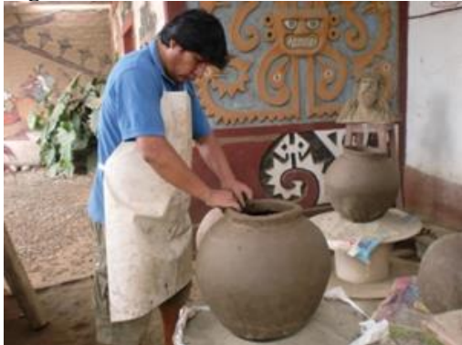
Figura 13. El artesano modela el borde final
