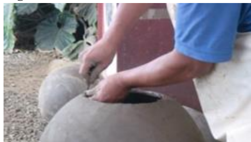
Figura 10. El artesano utiliza la herramienta denominada chaveta para hacer el borde de la vasija.
