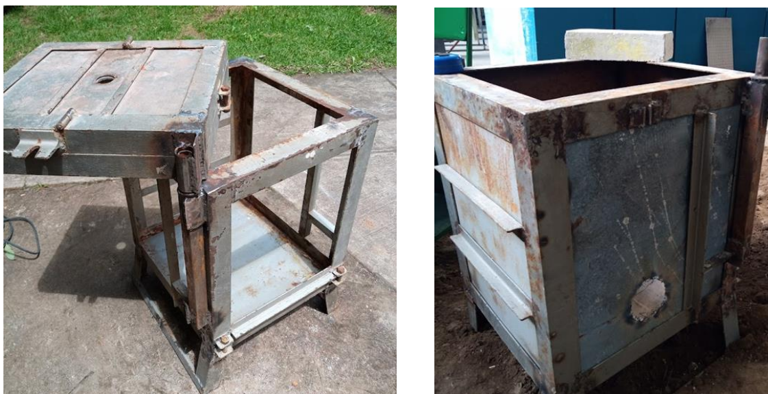
Figura 5 Proceso de reconstrucción de estructura obsoleta para la construcción del nuevo horno de fusión
