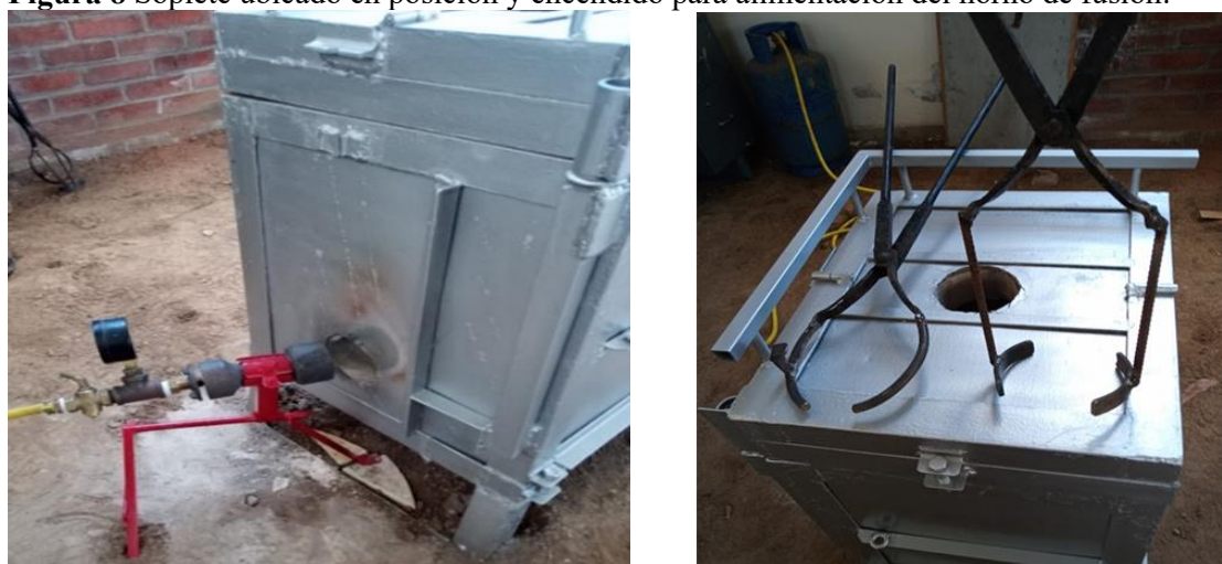
Figura 8 Soplete ubicado en posición y encendido para alimentación del horno de fusión.
