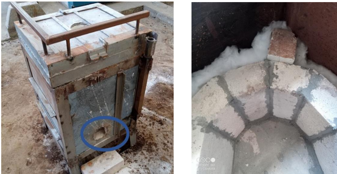
Figura 6 Estructura con adaptación de orificio lateral para soplete y disposición del material refractario
