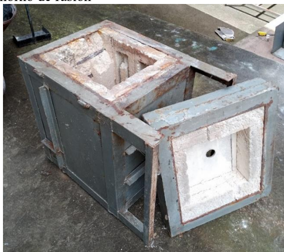
Figura 3 Imagen de horno eléctrico obsoleto destinado a reutilización para construcción de nuevo horno de fusión
