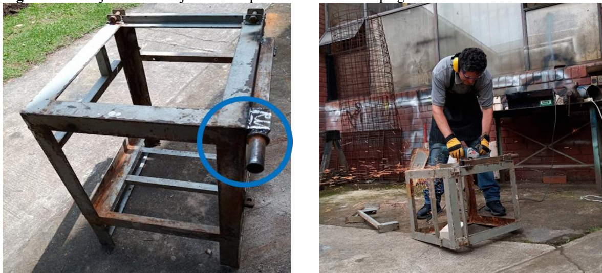
Figura 4 Montaje lateral de eje de acero para adecuación de tapa giratoria.
