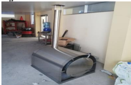
Figura 10. Estructura metálica de acero inoxidable del horno mejorado.
