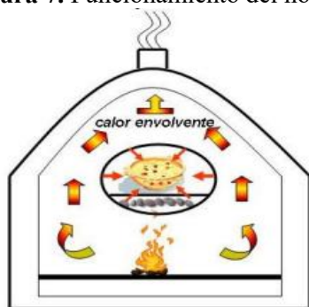
Figura 7. Funcionamiento del horno mejorado
