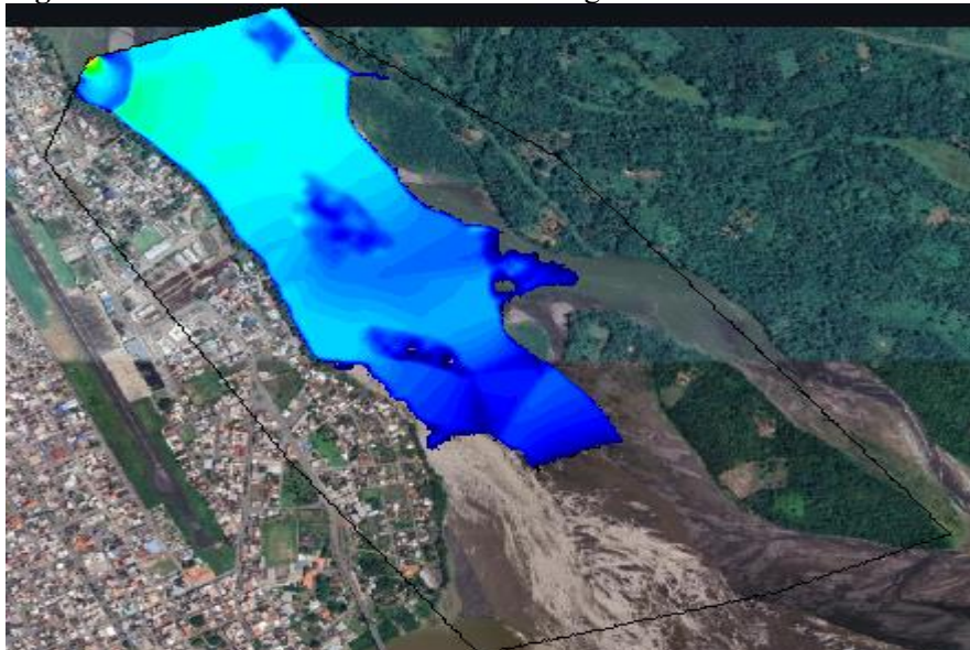
Figura 12. Inicio de la simulación en Iber según las condiciones de contorno.
