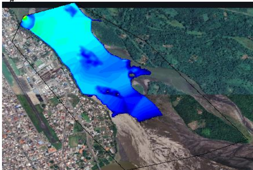
Figura 4. Inicio de la simulación en IBER
