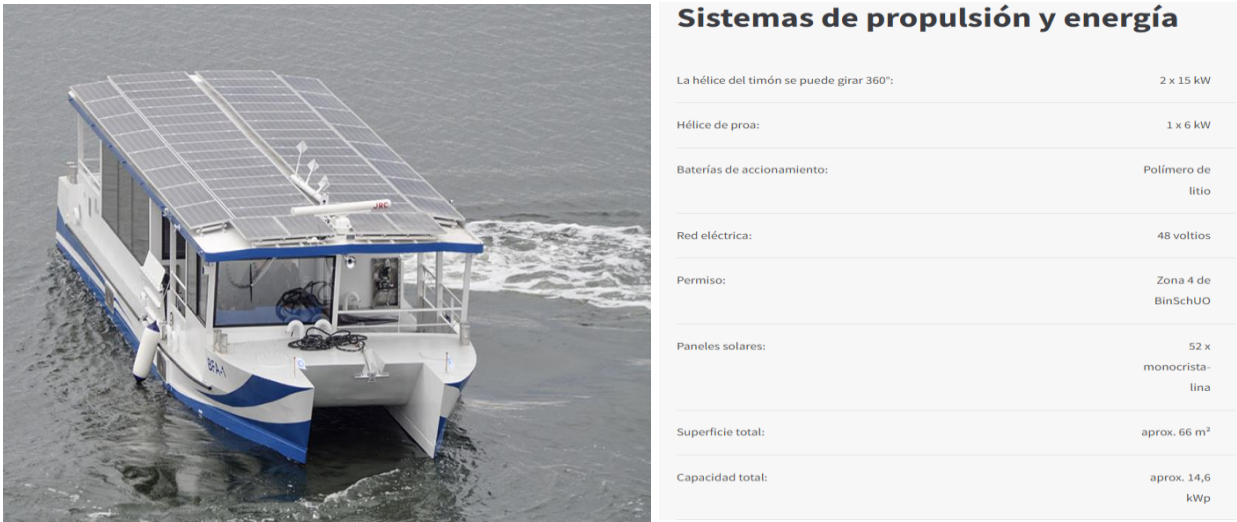
Figura 7 Embarcacion totalmente eléctrica Ampereship modelo ASP-60 con sus principales características.
