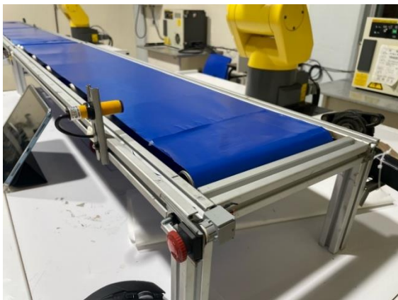
Figura 5 Ensamble de dispositivos, sensores y paro de emergencia en la banda transportadora.
