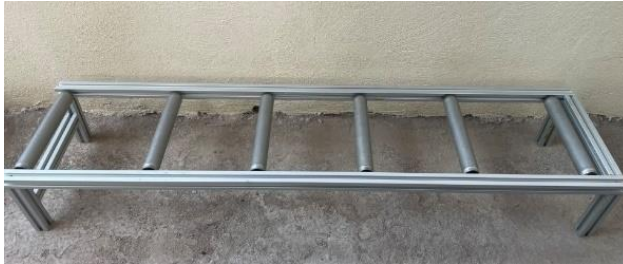
Figura 4 Estructura de banda con rodillos de \frac{1}{2} x 250mm.
