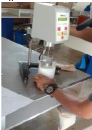
Figura 2. Toma de lectura de la viscosidad de la muestra a 28, 35 y 45°C.
