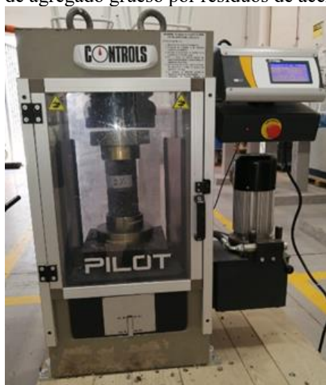
Figura 2. Prueba de resistencia a la compresión de especímenes de concreto permeable con sustitución de agregado grueso por residuos de acero de corte por plasma.
