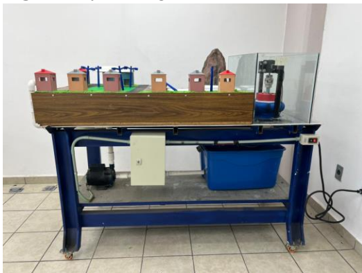
Figuras 2 y 3. Imágenes reales del banco hidráulico con turbina Francis y Generador de CC.
