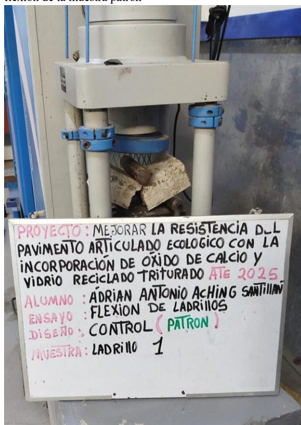
Figura 05. Comportamiento de la muestra tras el ensayo a flexión de la muestra patrón
