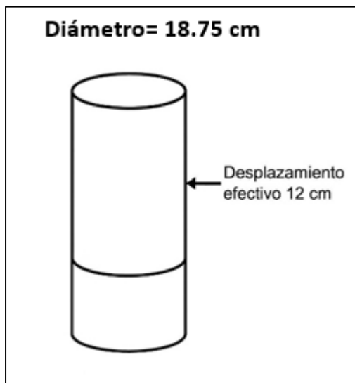
Figura 4. Medidas del cilindro de bombeo del Sistema tope-bomba.
