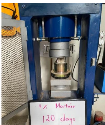
Figura 2 Ensayo a la resistencia a la compresión axial
