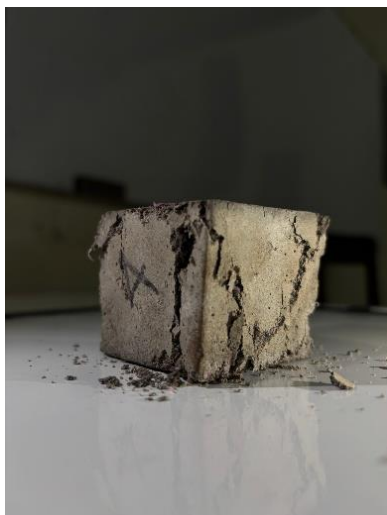
Figura 9 Espécimen cubico de mortero evaluado a la resistencia a la compresión.
