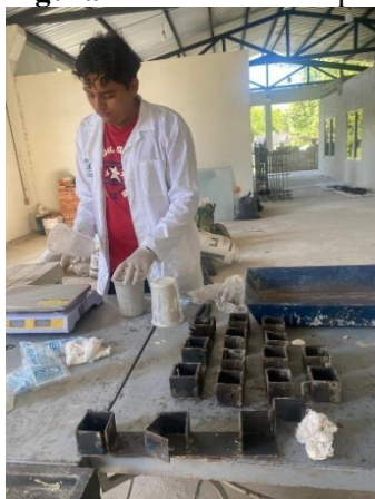
Figura 1 Elaboración de probetas de mortero
