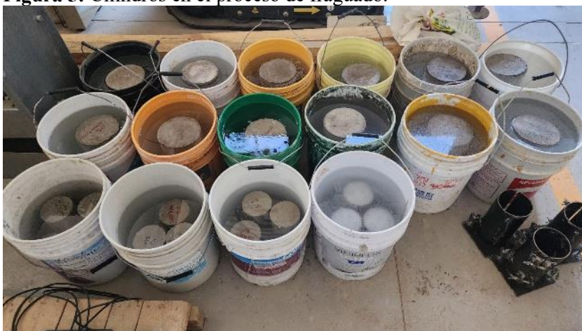
Figura 5: Cilindros en el proceso de fraguado.
