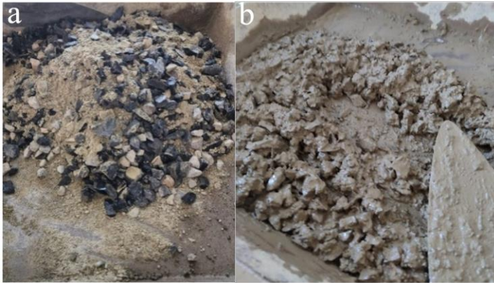
Figura 4: a) Mezcla de agregados pétreos y cemento b) Mezcla homogénea.
