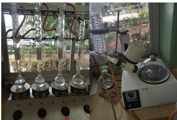
Fotografía 4.-Procesamiento de la muestra en equipo Soxhlet y Rotovapor.
