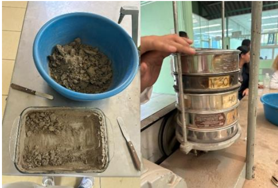
Fotografía 3.-Cribado del suelo
