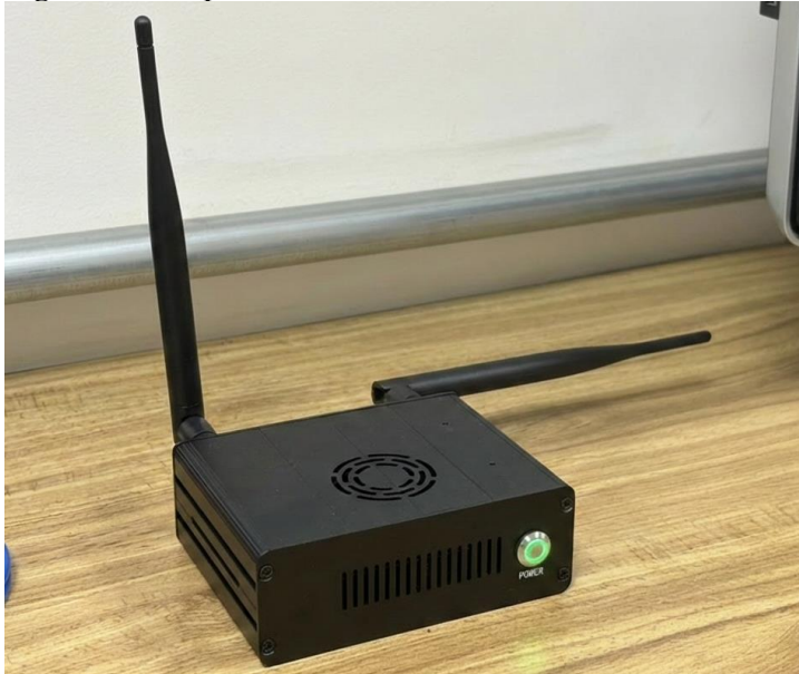
Figura 2. Computadora embebida NVIDIA Jetson Orin Nano donde se implementa el sistema.
