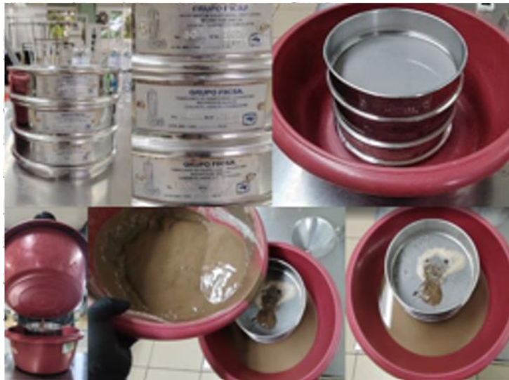
Fotografía 4.- Recolección de lixiviado del lavado de suelos
