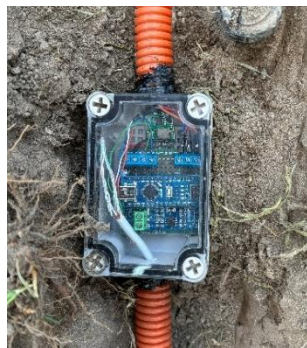
Figura 4. Caja estanca enterrada con el Arduino Nano y el módulo RS485
