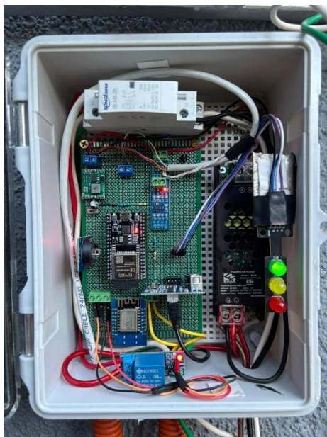
Figura 8. Interior del gabinete terminado — ESP32, Wemos, contactor, fuente, relay y semáforo
