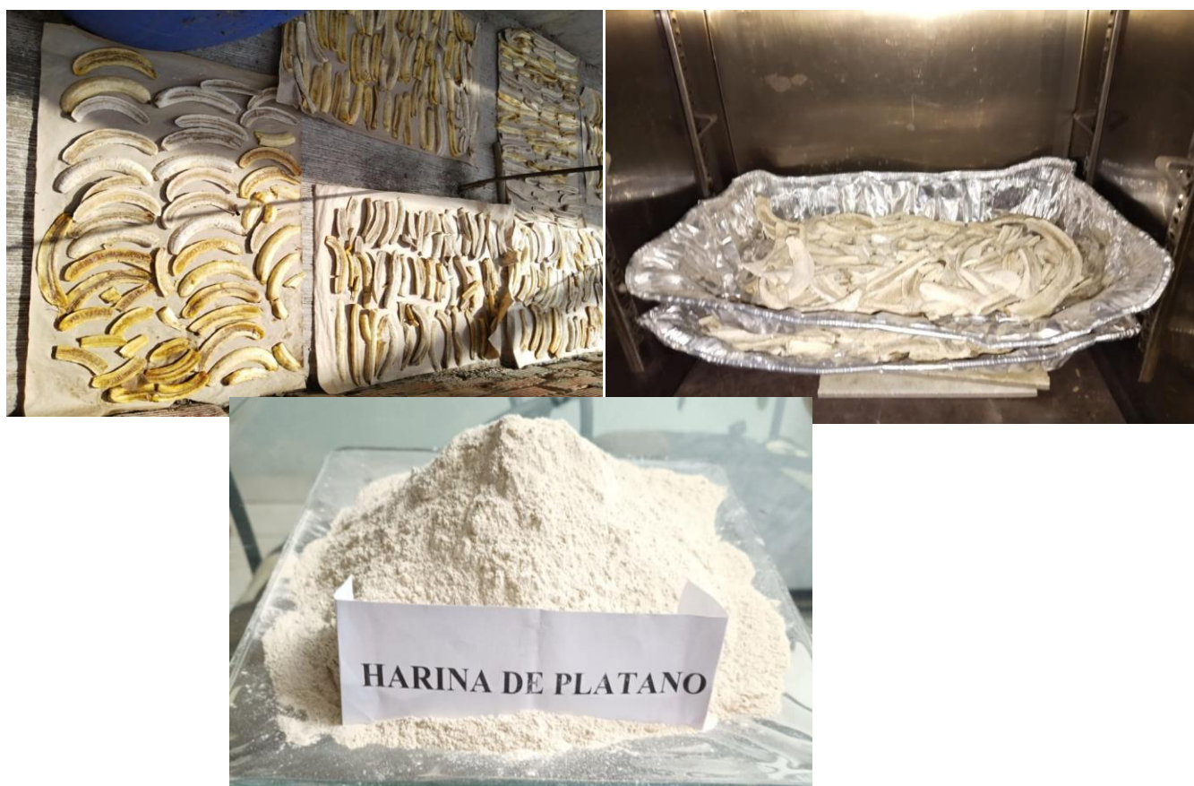
Figura 2. Secado de pulpa de plátano Musa acuminata AAA Cavendish
