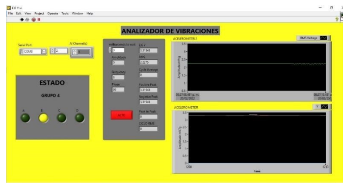
Figura 11. Lectura de sensor MMA7631 eje Y con Linx para el motor 2
