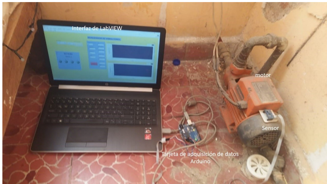
Figura 8. Prueba hecha en el motor 1
