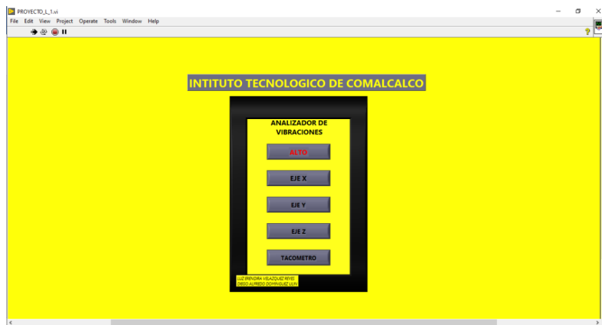
Figura 5. Interfaz en LabVIEW para el análisis de las vibraciones.
