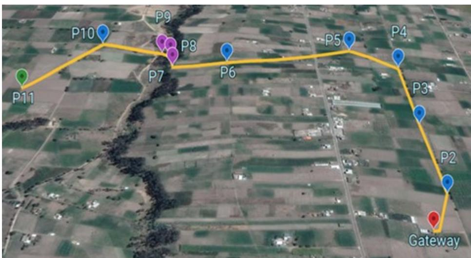
El Gateway LoRa está instalado en el techo de una casa a 3.3 metros de altura, con la antena vertical. La antena omnidireccional tiene una ganancia de 2 dBi y un rango de frecuencia
