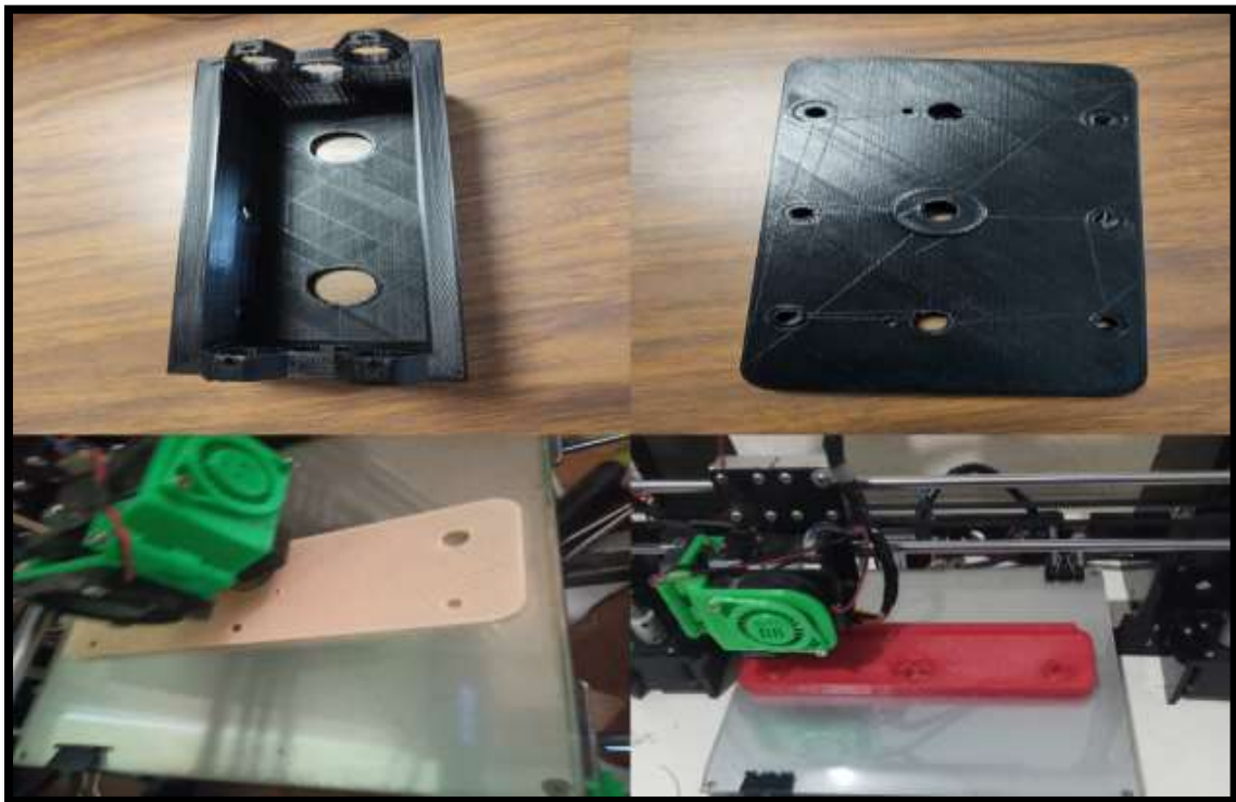
Figura 6. Impresión de Piezas con PLA.
