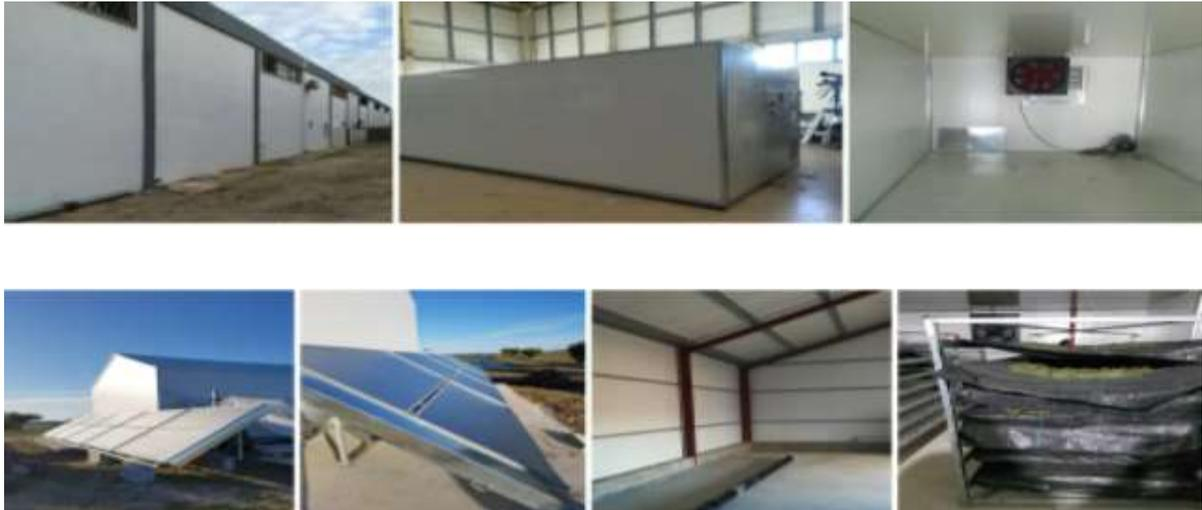
Figura 12: Túnel de secado solar (secado, deshidratación y deshumidificación)
