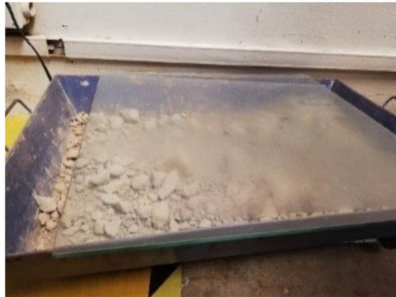
Posteriormente se realizaron los pesos volumétricos del material, por su parte del peso volumétrico seco, con esta se logró determinar la masa volumétrica seca del material en estado suelto, basada en la relación de la masa de sólidos del material y el volumen total, después de que la masa ha sido corregida considerando el contenido de agua. Por otro lado, se obtuvo el peso volumétrico seco varillado.
