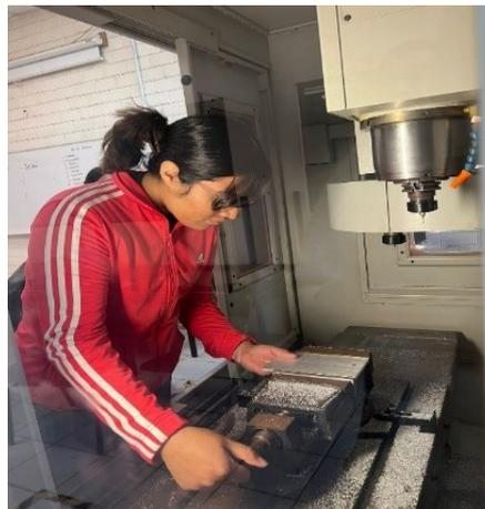
En la Figura 7, se muestra cómo se determinó la altura de la herramienta de 1/16 plg de diámetro, al observar que se desprenden diminutas rebabas de aluminio al entrar en contacto la herramienta de corte con el material de aluminio, ese mismo procedimiento se utilizó con el cortador de 1/8 plg de diámetro.
