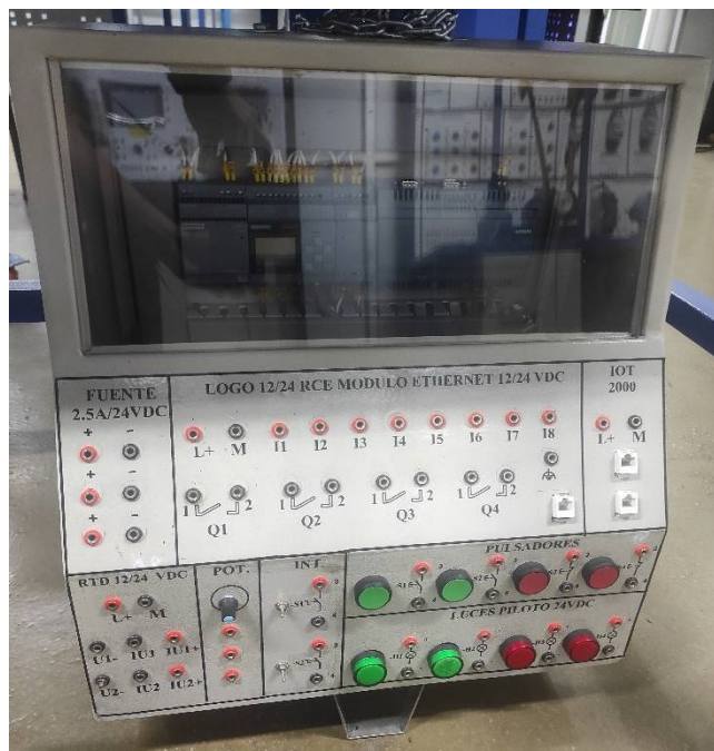
Figura 3. Módulo didáctico de automatización.
