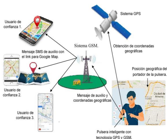
Figura 1. Arquitectura del sistema de geolocalización para personas vulnerables: botón de pánico SGPVBP.
