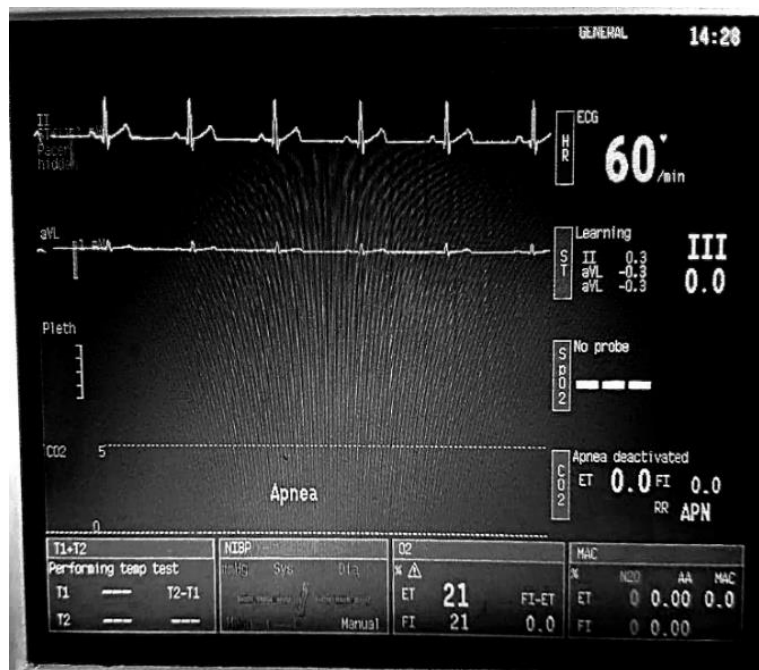
Figura. 11. Vista de la señal ECG en el monitor de signos vitales, generada por el microcontrolador STM32.
