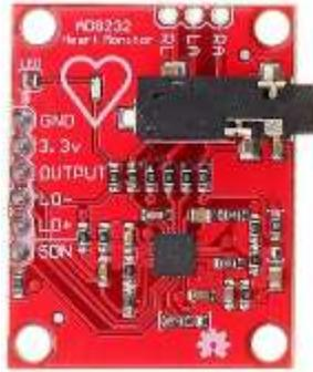
**Figura 2.** Módulo AD8232 para adecuación de señal de electrodos. Obtenida de uElectronics
