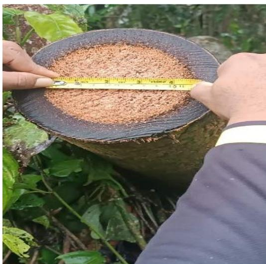
**Fotografía 07:** Medición del diámetro sin corteza
