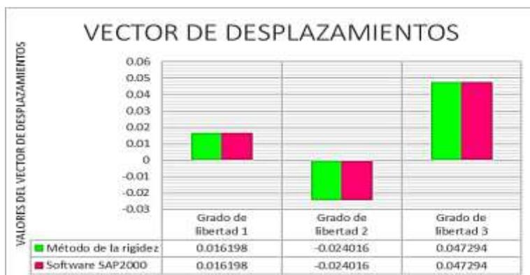
*Nota.* Tabla 12. En la figura 15 se puede observar que el vector de desplazamientos hallados por el método de la rigidez y el software SAP2000, no presentan ninguna variación en los resultados.
