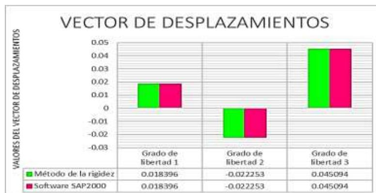
*Nota.* Tabla 13. En la figura 16 se puede observar que el vector de desplazamientos hallados por el método de la rigidez y el software SAP2000, no presentan ninguna variación en los resultados.
