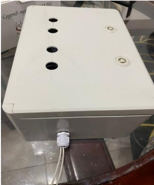
Imagen 1 Perforación para la ensamblar las señales y pulsadores
